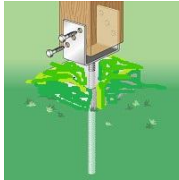
Slika br. 2. Metalna stopa/držač stubova
