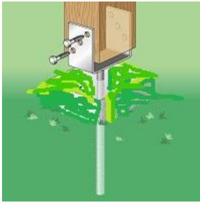
Slika br. 2. Metalna stopa/držač stubova
